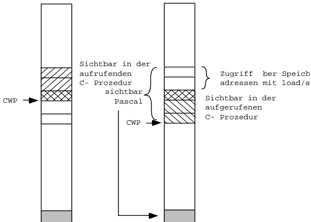
Bei einem Prozeduraufruf wird dann der CWP nur weitergeschaltet, so daß sich der Bereich der Übergabe- und Aufrufparameter der beiden Prozeduren überlappen. Das erspart einen Stack für den Prozeduraufruf (bis auf das PSW, das nach wie vor dort gerettet werden muß) und beschleunigt die Parameterübergabe.
