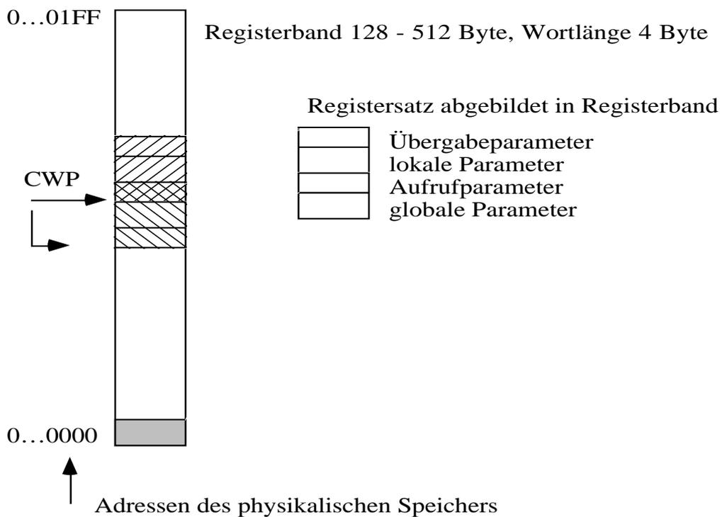
Der im Programm ansprechbare Registersatz besteht aus 4 Teilen: einem Satz globaler Register abgebildet auf die gleiche Stelle im Registerband für alle Prozeduren, den Übergabeparameter für einen Prozeduraufruf, den lokalen Variablen der Prozedur und den Aufrufparametern der nächsten Prozedur.
